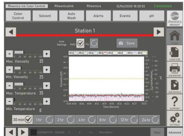
Die Viskositätssollwerte, Toleranzen, Pantone-ID, Farbe, Name des Laufs und andere Auftragsdetails werden in einer Auftragskonfigurationsdatei gespeichert. Gespeicherte Aufträge können in das System geladen werden, um Wiederholungsaufträge auszudrucken. Die Ausführung von Wiederholungsaufträgen wird viel einfacher, wodurch Rüstausschuss vermieden und die Rüstzeit verkürzt wird.
