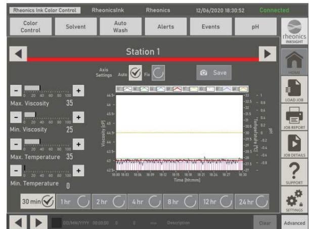
I setpoint di viscosità, le tolleranze, l'ID pantone, il colore, il nome della corsa e altri dettagli del lavoro vengono archiviati in un file di configurazione del lavoro. I lavori salvati possono essere caricati nel sistema per stampare ordini ripetuti. L'esecuzione di lavori ripetuti diventa molto più semplice, eliminando gli scarti di configurazione e riducendo i tempi di configurazione.
