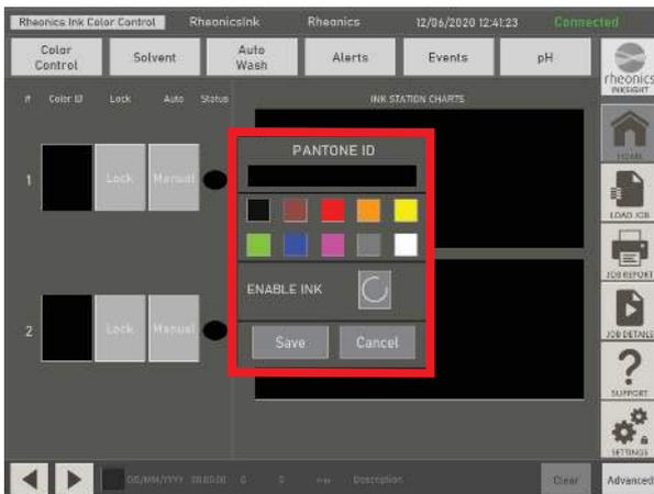
El botón 'Lock' tiene dos funciones: selecciona el valor de viscosidad medido actual como punto de ajuste y permite el control automático de la tirada de impresión.
