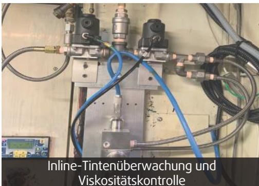
Inline-Tintenüberwachung und Viskositätskontrolle
