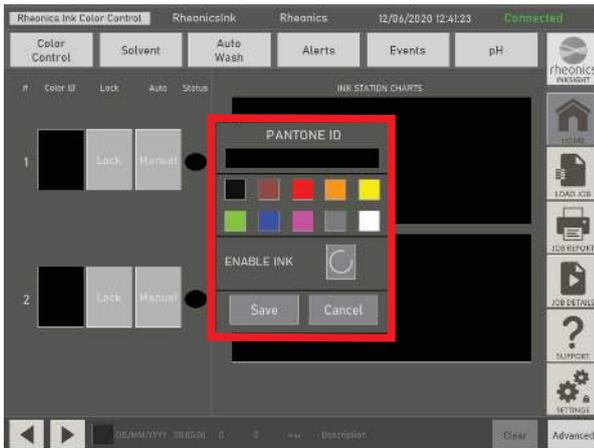
Der „Lock“ Knopf hat zwei Funktionen: Es wählt den aktuell gemessenen Viskositätswert als Sollwert und ermöglicht die automatische Steuerung über den gesamten Druckdurchlauf.
