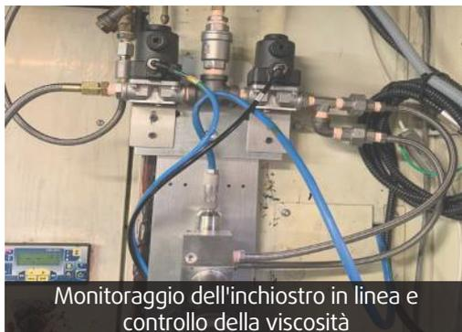
Monitoraggio dell'inchiostro in linea e controllo della viscosità
