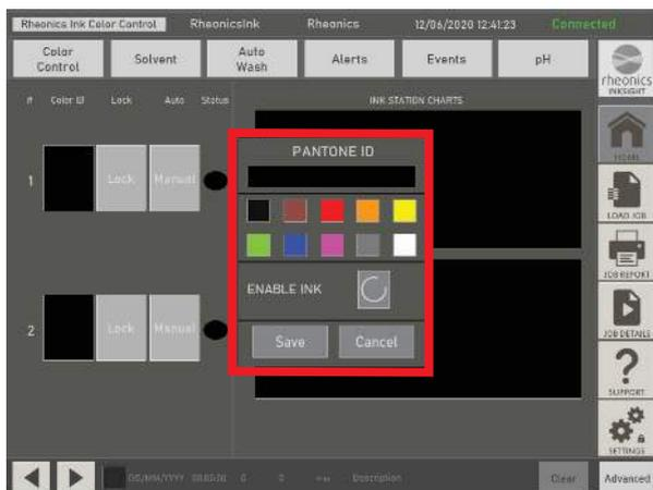
Il pulsante "Lock" ha due funzioni: seleziona il valore di viscosità misurato corrente come setpoint e consente il controllo automatico durante la tiratura.
